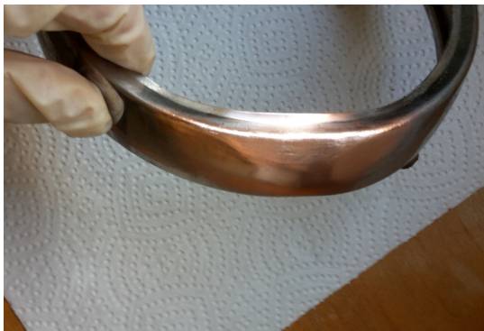
über Leitspachtel drüberverkupfert
