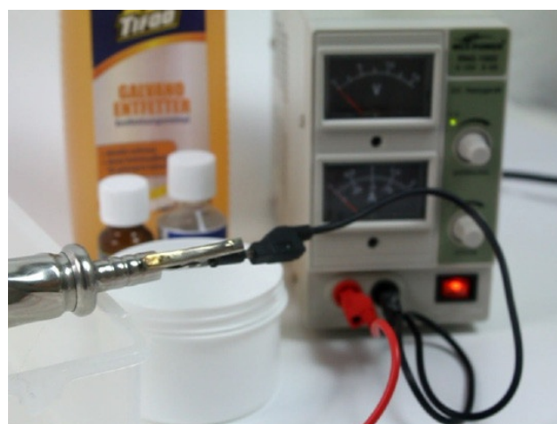
Connectez la pièce à façonner avec la pince crocodile
