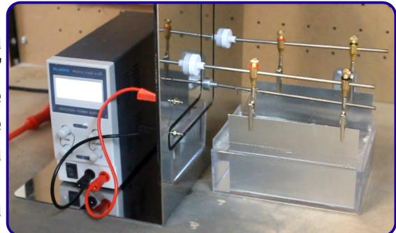
Per la superficie della componente abbiamo ricercato una superficie approssimativamente di  $50 \text{ cm}^2$  ( $0,5 \text{ dm}^2$ ). Poiché come valore guida di massima vale una densità di corrente di  $2,5 \text{ A/dm}^2$ , la corrente è stata dunque poi gradualmente portata ad 1,25 A.
