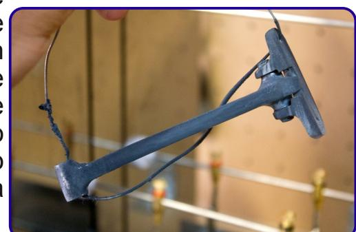
In seguito l' oggetto è stato ancora sottoposto a lucidatura a specchio con PowerPolish di Tifoo e con un po' di lana d'acciaio. Il risultato è uno strato di zinco brillante. Per proteggere l' oggetto ancora a lungo dalla ruggine di zinco e dalla corrosione, è stato immerso nella cromatura blu di Tifoo. A seguire vede il confronto tra il prima e il dopo della componente del modello galvanizzato.
