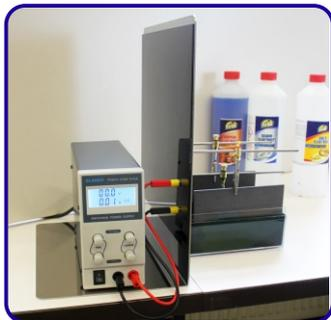
**6** Un ulteriore vantaggio dell' installazione è la riduzione al minimo dei cavi necessari. Collegli entrambi i cavi da 0,5 m di lunghezza nelle rispettive prese. Collegli il polo positivo con la presa in alto (dunque con la "L") e il polo negativo con la presa in basso (anodo) (vedi schizzo della vista frontale accanto).
