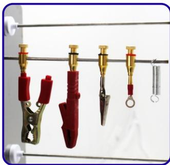
**5** Il fissaggio di anodi e pezzi può avvenire per mezzo di pinze, ganci e occhielli numerosi e diversi, adattati alle Sue esigenze. Grazie ad un semplice collegamento e scollegamento alle/dalle spine a banana possono essere fissate pinze a coccodrillo così come altri fissatori come per esempio ganci, capicorda, molle o tenaglie. Presti attenzione ad un raccordo solido e conduttore innanzitutto. Gli anodi possono essere attaccati senza problemi con le pinze a coccodrillo fornite.
