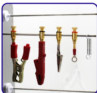
**5** Die Befestigung von Anoden und Werkstücken kann mit vielen verschiedenen und an Ihre Bedürfnisse angepassten Klemmen, Haken oder Ösen erfolgen. Durch einfaches Auf- und Abstecken an die Bananenstecker können sowohl Krokodilklemmen als auch andere Befestiger wie z.B Haken-Kabelschuhe, Federn oder Zangen befestigt werden. Achten Sie auf eine feste und vor allem leitende Verbindung. Die Anoden können problemlos mit den gelieferten Krokodilklemmen angebracht werden.
