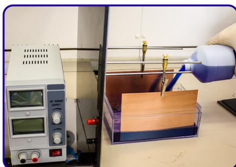
**7** Der eigentliche Galvanisierungsschritt erfolgt dann nach den Bedingungen des jeweiligen Elektrolyten (siehe hierfür die entsprechende Anleitung). Bewegen Sie die Anoden oder die Anode (z.B. bei einem Kupferelektrolyt eben Kupferanoden) in das Bad und füllen Sie dann vorsichtig den jeweiligen Elektrolyten ein.
