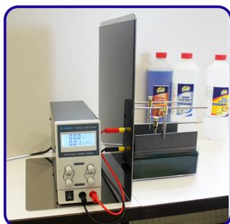
**6** Ein weiterer Vorteil des Aufbaus ist die Reduzierung der benötigten Kabel auf ein Minimum. Stecken Sie die beiden Kabel in die entsprechenden Buchsen. Den Pluspol verbinden Sie mit der oberen Buchse (also außerhalb des „L“s) und den Minuspol mit der unteren Buchse (Anode) (siehe nebenstehende Skizze der Frontansicht).
