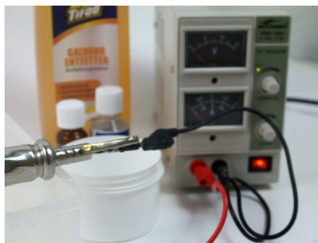
Collegamento del pezzo con il morsetto a coccodrillo
